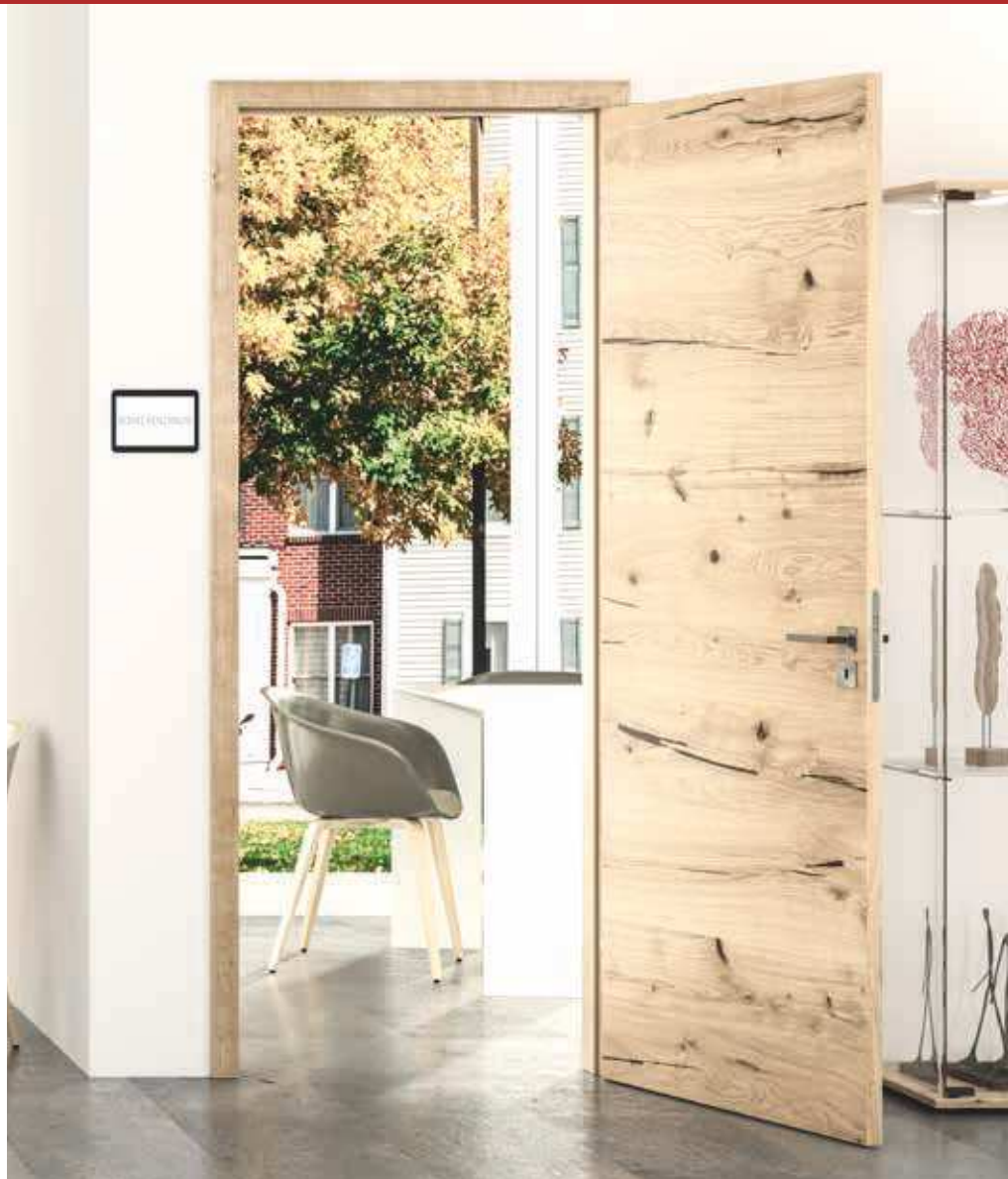
STANDARD GLATT Balkeneiche Roheffekt geplankt quer furniert, System KÖNOPLAN (stumpf einschlagend), verdeckt liegende, mehrdimensional verstellbare Türbänder, Türdämpfung ActiveStop, Zarge Standard kantig, Eiche Kastell Roheffekt, Drückergarnitur Palma, Edelstahl, planeo, Flachrosette quadratisch
